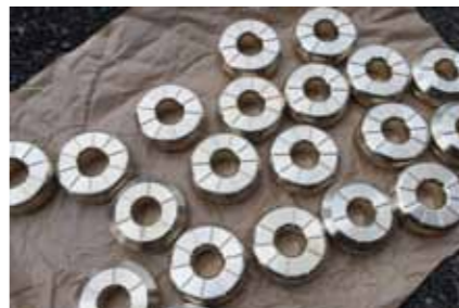
この日のために用意されたF599専用のワッシャー（ホイール・インシュレーター）「PB-599」
