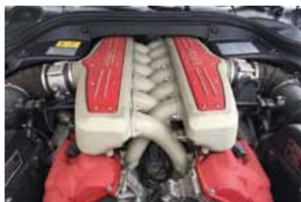
F599のフロントボンネットの下にはV型12気筒、6リッターのエンジンを収納
