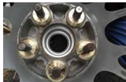
ハブとホイールの間に「PB-599」を取り付け
