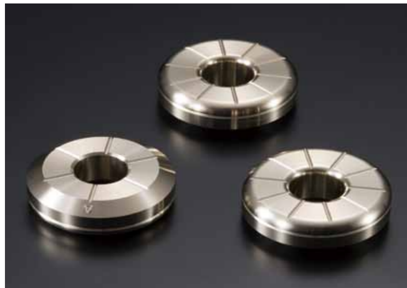
■F599のチューニングから生まれたホームオーディオ用のインシュレーター Rosenkranz PB-599 ●サイズ：高さ12.25mm×直径38.5mm●質量：92g ●構造：上面に10本のスリット、下面に上面とは逆の対角線上に6本のスリット ¥15,000(1個・税別) ※発売記念価格¥12,000(1個・税別・200個まで、または、'17.1月末まで)
