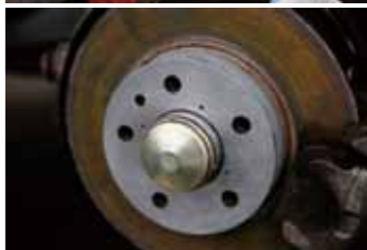
ホイールを受ける車体側のハブの部分もヤスリできれいに洗浄する。写真右が洗浄後の状態。時間をかけて丹念に磨き上げていった
