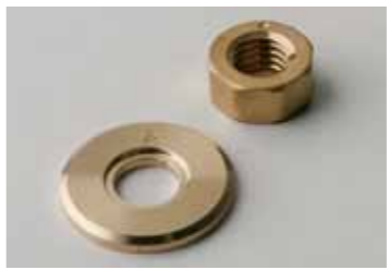
「オートローゼン」特製のワッシャーとナット。シリコンが3%混ざっているエコーラスを素材として、無垢の棒の製造段階から上記のような方向性を管理して作られている
