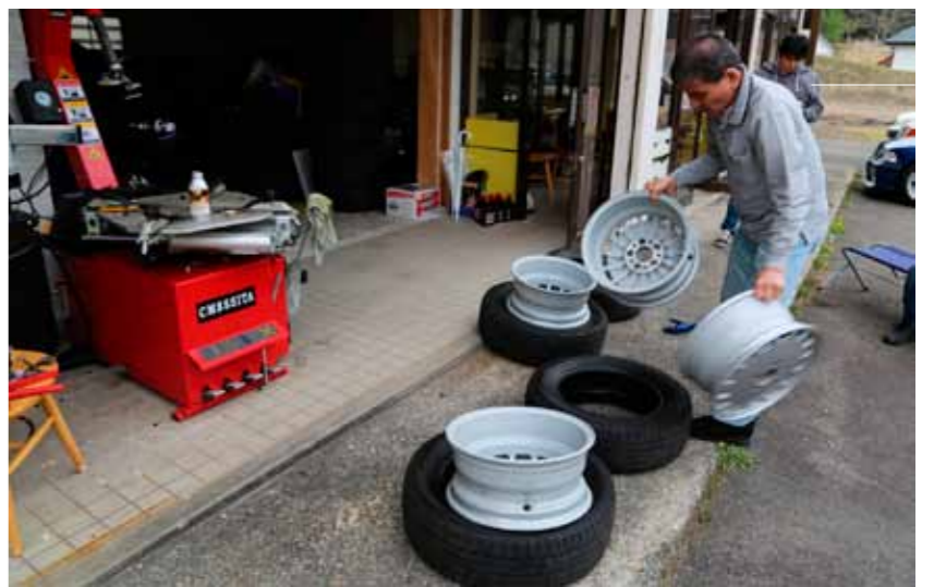
方向性を判断しながら「このタイヤにはこのホイールを」といったような相性をチェックし、タイヤとホイールの振動の抜ける方向が合うように組み込んでいく
