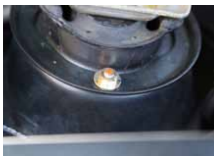
フロントショックアプソーバー取り付け部のワッシャーとナットを「オートローゼン」の特注パーツに交換
