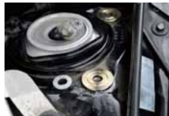
フロントのショックアブソーバー取り付け部のワッシャーを「オートローゼン」の特注パーツに交換。その効果を「コーナーに進入した時に、チューン前とは圧倒的な安全マージンの差を感じました」と益野さんは語る
